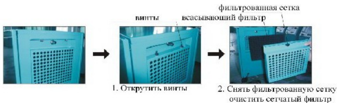
Очистка сетчатого фильтра
